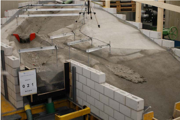
Modellanlage des Ausleitbauwerks (rot) mit ausgeleitetem Modellmurgang Lab models of the diversion channel (red) and transported material from a simulated debris flow
