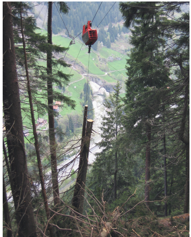
Holztransport mit Seilkran oberhalb der Nationalstrasse Hauling with a cable crane above the highway.
